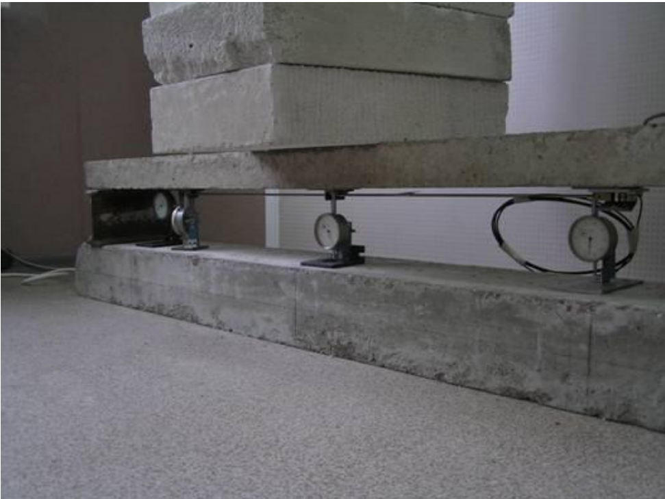
Рис.7 Испытания ВОДД-2 на железобетонной перемычке с контролем вертикальных и горизонтальных перемещений индикаторами часового типа
