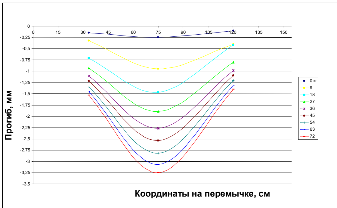
Рис. 9 Прогибы перемычки 1ПБ-16-1 под действием нагрузки
